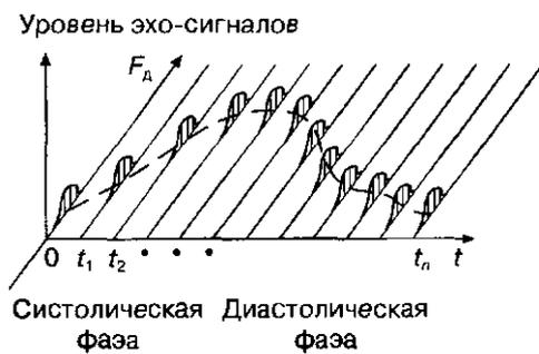
Рис. 15. Изменение спектра частот доплеровского сдвига во времени.
