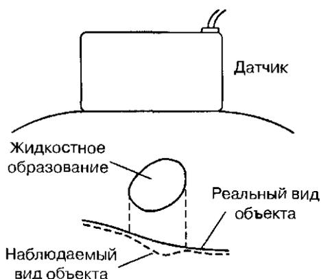
Рис. 46. Артефакт изменения формы при наблюдении объекта, расположенного за жидкостным образованием.
