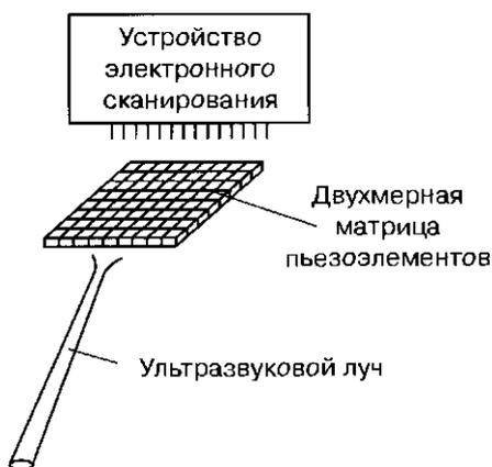
Рис. 6. Получение трехмерных изображений с помощью датчика с двухмерной матрицей пьезоэлементов.
