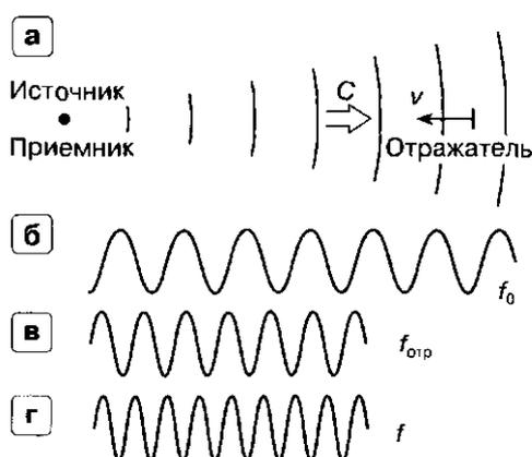
Рис. 3. Эффект Допплера при движении отражателя, а - источник и приемник совмещены и неподвижны, отражатель движется к ним со скоростью V. б- колебания источника - частота f<sub>0</sub>. в - колебания, приходящие на отражатель, г - колебания в приемнике.
