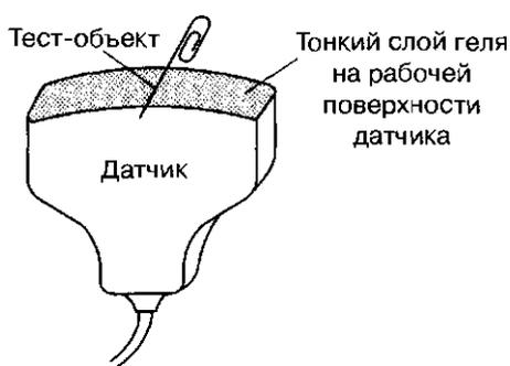
Рис. 30. Определение части элементов (или части апертуры) датчика, формирующих УЗ луч.
