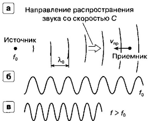
**Рис. 1.** Эффект Допплера при движении приемника. **а** – приемник движется к источнику со скоростью  $v_{пр}$ . **б** – колебания, излучаемые источником, – частота  $f_0$ . **в** – колебания в приемнике – частота  $f > f_0$ .
